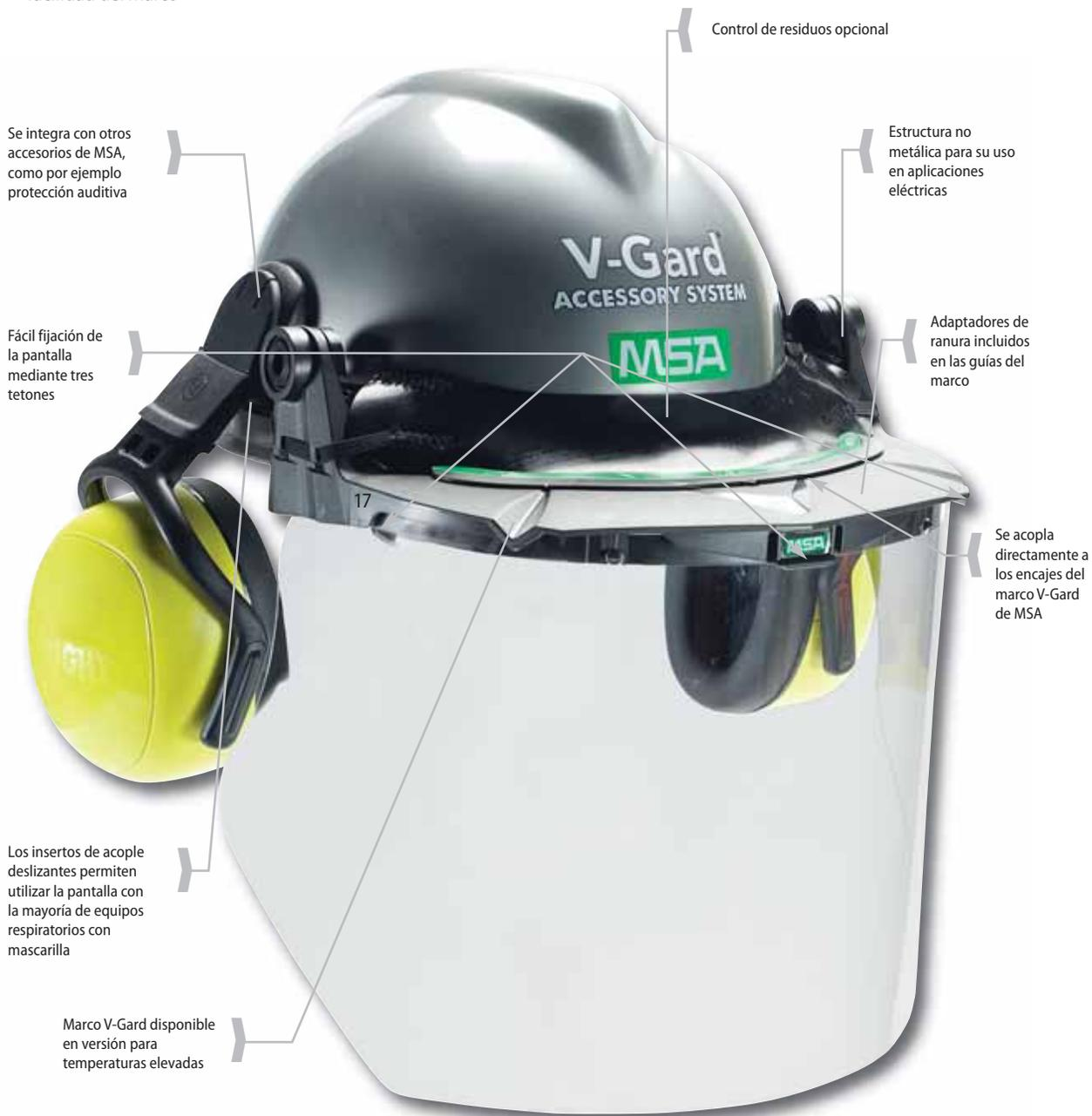
*Marco V-Gard para cascos con ranuras, con control de residuos. Representado con pantalla incolora de policarbonato y orejas left/RIGHT (de alta atenuación).*
